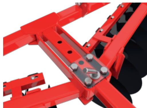
Facilidad para cambiar y fijar los ángulos de trabajo sin ninguna posibilidad de error y con comodidad para el operario.
