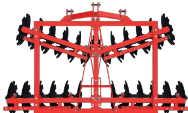
Ángulos precisos para no tener esfuerzos ni a la derecha ni a la izquierda. Tres posiciones de trabajo para suelos duros, corrientes y suaves; y una cuarta a 0° para la sección trasera para tapar semillas. Distancia exacta entre secciones de discos para no formar caballones o montículos centrales.
