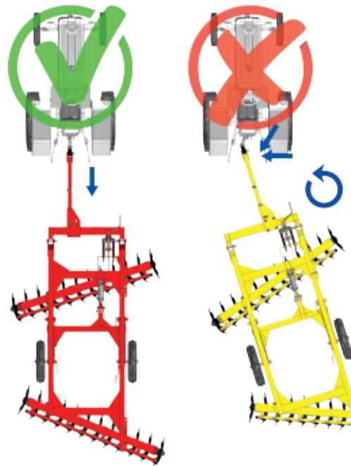
Se alinea fácilmente lo cual elimina esfuerzos dañinos para el tractor, alarga su vida y reduce costos de mantenimiento y combustible.
